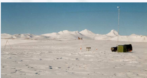
Sjálfvirk veðurstöð Landsvirkjunar við Setur, fyrir sunnan Hofsjökul. Í 10 m háu mastri er vindmælir og í 2 m hæð eru hita- og rakamælur. Á miðri mynd sést vindrafstöð fyrir stöðina og hægra megin við hana er úrkomumælirinn. Lengst til vinstri má sjá þrífót undir snjódýptarmæli, sem mælir fjarlægð niður að snjóyfirborði. (mars 1998)
