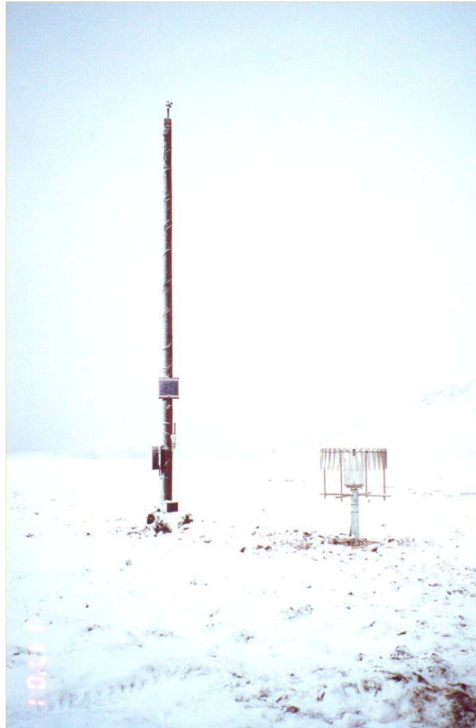
Mynd 2. Sjálfvirk veðurstöð Veðurstofunnar á Ölkelduhálsi. Ljósm. Þórður Arason, janúar 2001.
