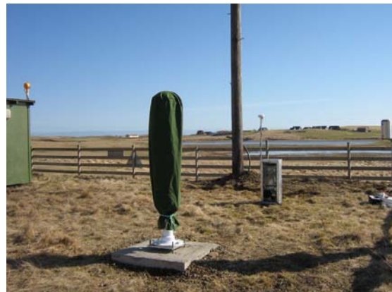
Mynd 15. ALDF-eldingastöðin á Langhólanesi í Hornafirði. a. Hjálmur tekinn ofan og sést þá stefnuvirka lofnetið. b. Segldúkur er breiddur yfir nemann sem veðurhlíf.
