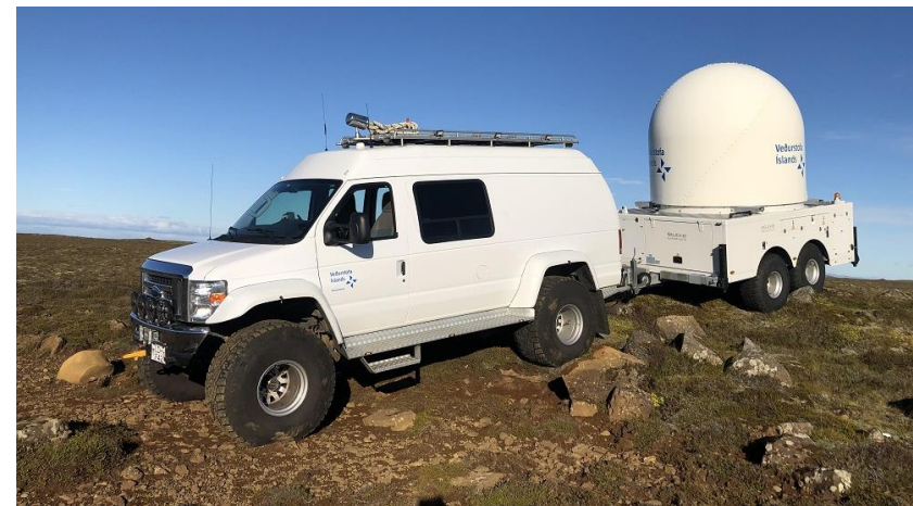
Selex færanleg X-band veðursjá. Aðaltilgangur að fylgjast með sprengigosum. Ljós. Hermann Arngrímsson september 2021.
